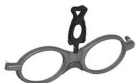
Чтобы отделить носовой упор от оправы, используйте зажим, расположенный посередине регулировочной планки носового упора. Если вы нанесли капельку клея, разогрейте пинцет перед использованием.
